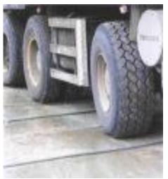
Pour les plaques de 20 mm d'épaisseur, charge admissible **jusqu'à 80 tonnes/m²** sur sol très dur et lisse, sur sol plus fragile environ 5 tonnes/m².
