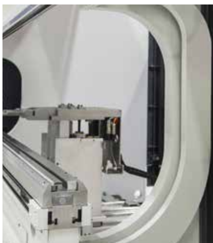
Augmentation de la distance coulisseau-table/course du coulisseau, col de cygne plus grand avec des incréments de 100 mm
