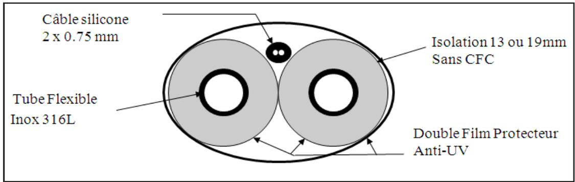
**Tube en acier inoxydable** ondulé et souple — qualité 1.4404 (316L)
