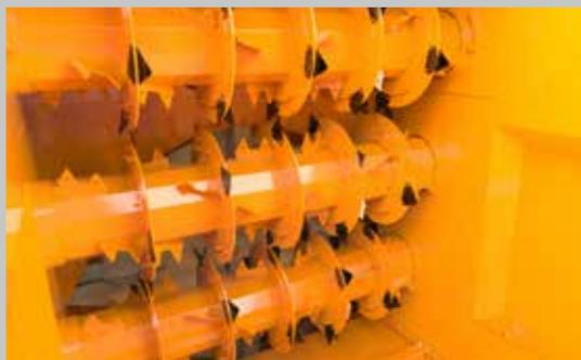
3 démêleurs à entraînement mécanique équipés de sections de coupe en V et de disques lisses pour permettre une coupe franche et précise de tous les fourrages même les plus difficiles (enrubannée humide)
