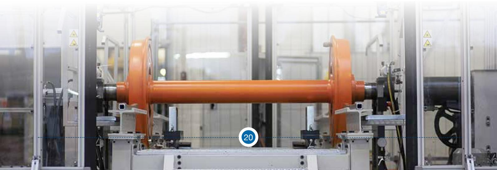
Ces machines se distinguent des autres producteurs par la résolution novatrice qui permet sans efforts d'ajuster la partie de bout de l'essieu monté avec une broche de la machine. C'est bien possible grâce à l'embrayage "flottant" qui est élaboré selon les types concrets des essieux montés. Ces machines permettent d'équilibrer les différents types des essieux montés qu'on utilise dans le monde en tenant compte un écartement différente des rails.
