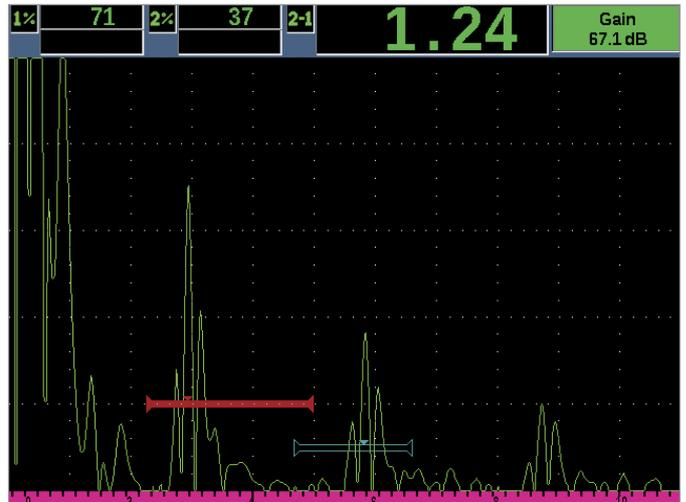
Fonction de mesure entre échos avec synchronisation des portes de l'EPOCH 650
