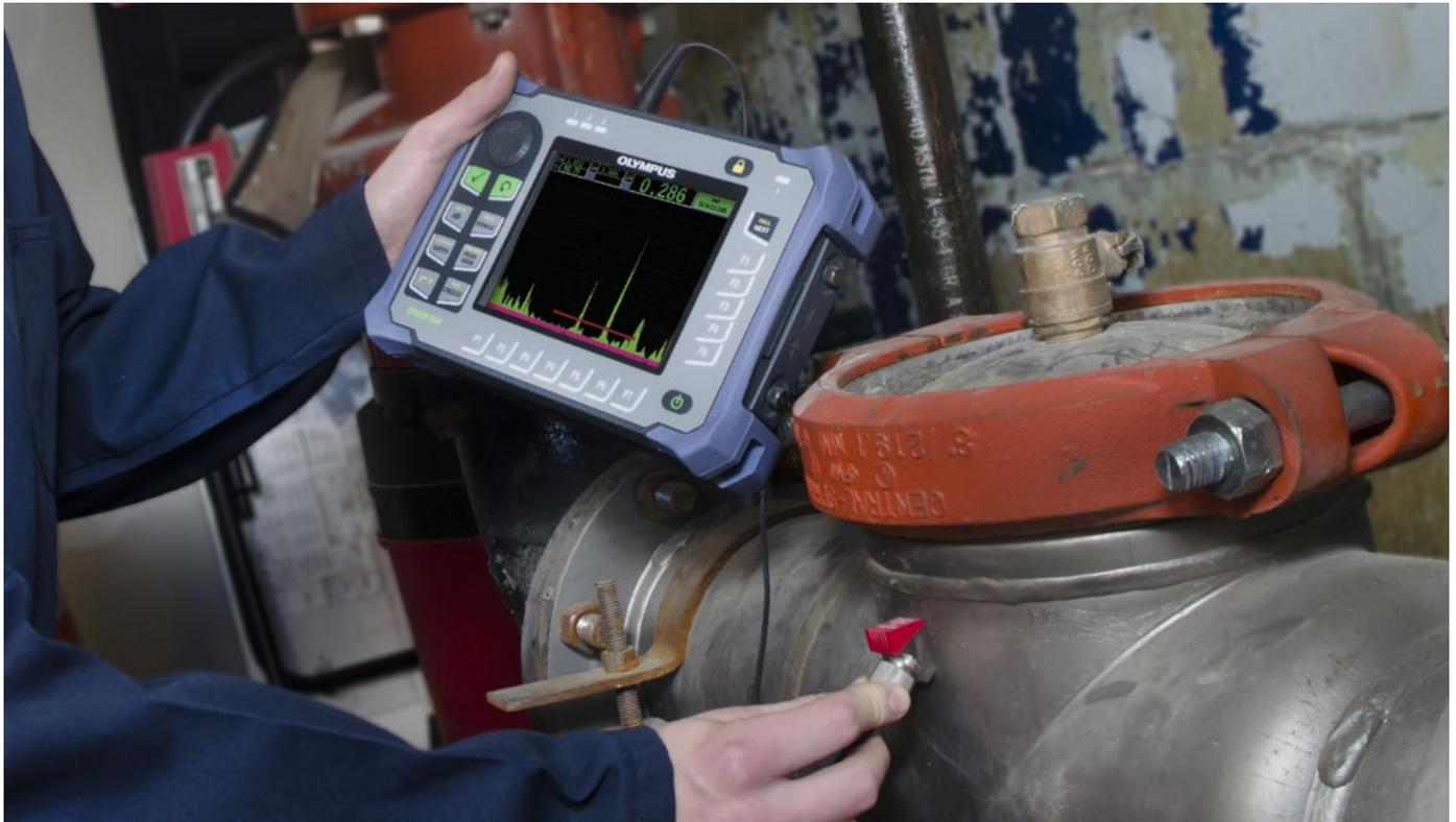
L'appareil de recherche de défauts par ultrasons numérique EPOCH 650 combine les capacités conventionnelles de détection de défauts d'Olympus et l'efficacité d'un appareil portable et intuitif. Il est doté d'un logiciel aux menus efficaces et de touches d'accès direct qui en font une excellente plate-forme de recherche de défauts d'une très grande simplicité d'utilisation.
