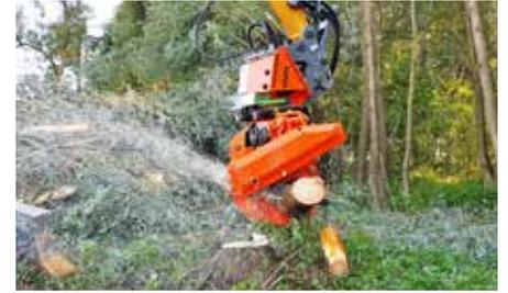
Tronçonnage en fagot et dépose rapide.
