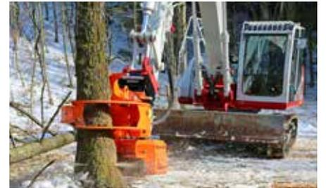
Tronçonnage en fagot et dépose rapide.
