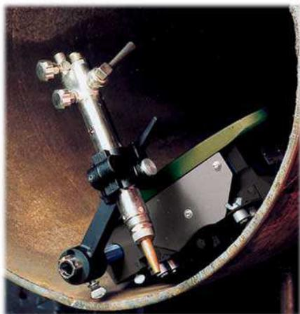
Coupe intérieure sur tube horizontal à partir de 24" et plus avec une épaisseur de 10 mm (3/8") à 51 mm (2").
