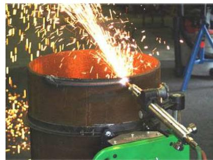
Coupe par l'extérieur sur tube horizontal ou vertical d'un diamètre extérieur de 168 mm et plus, d'une épaisseur de 10 mm (3/8") à 51 mm (2").
