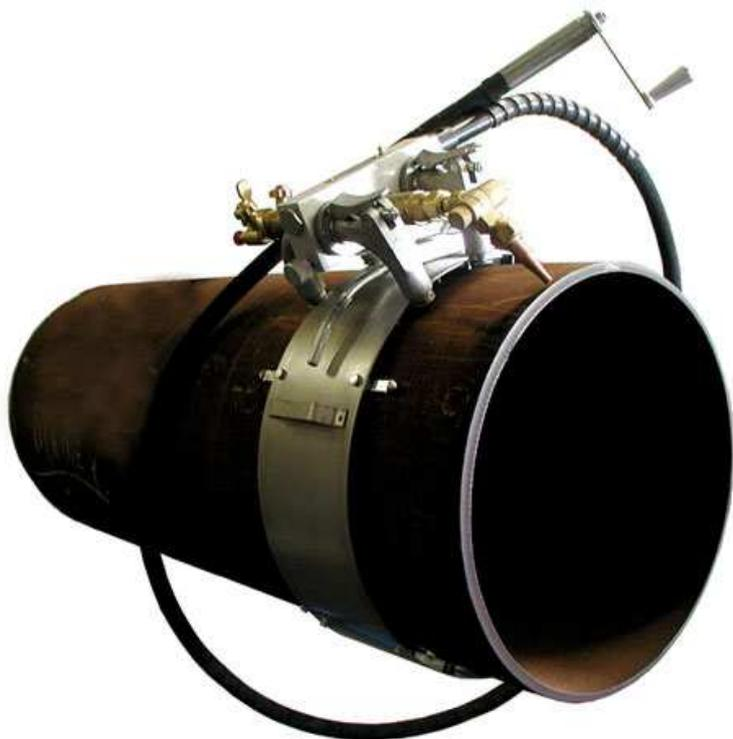
Pour la coupe oxyacétylénique manuelle ou motorisée, adaptable pour la coupe plasma. Utilisée sur les chantiers gazoduc et oléoduc, pour une qualité de coupe optimale.
