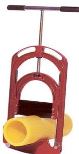
Pour tube PE SDR17 jusqu'à 315mm de diamètre, en moyenne et haute densité. Coupe parfaite pour l'électrofusion grâce à une lame revêtue Téflon. Le nouveau Modèle HPC8TN est équipé de 6 roulettes à la base permettant une coupe sans déformation ni rupture du tube durant la coupe.
