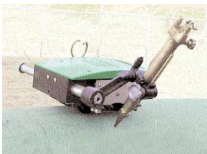
Coupe longitudinale sur tube vertical ou horizontal de diamètre 16" - 406 mm et plus, d'une épaisseur de 10mm (3/8") à 51 mm (2").
