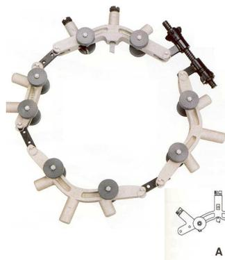
Équipé de roues guide permettant une coupe perpendiculaire parfaite, réalise simultanément une coupe et un chanfrein de 15° de chaque côtés de la coupe.
