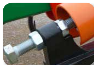
Système régulation pression ressorts
