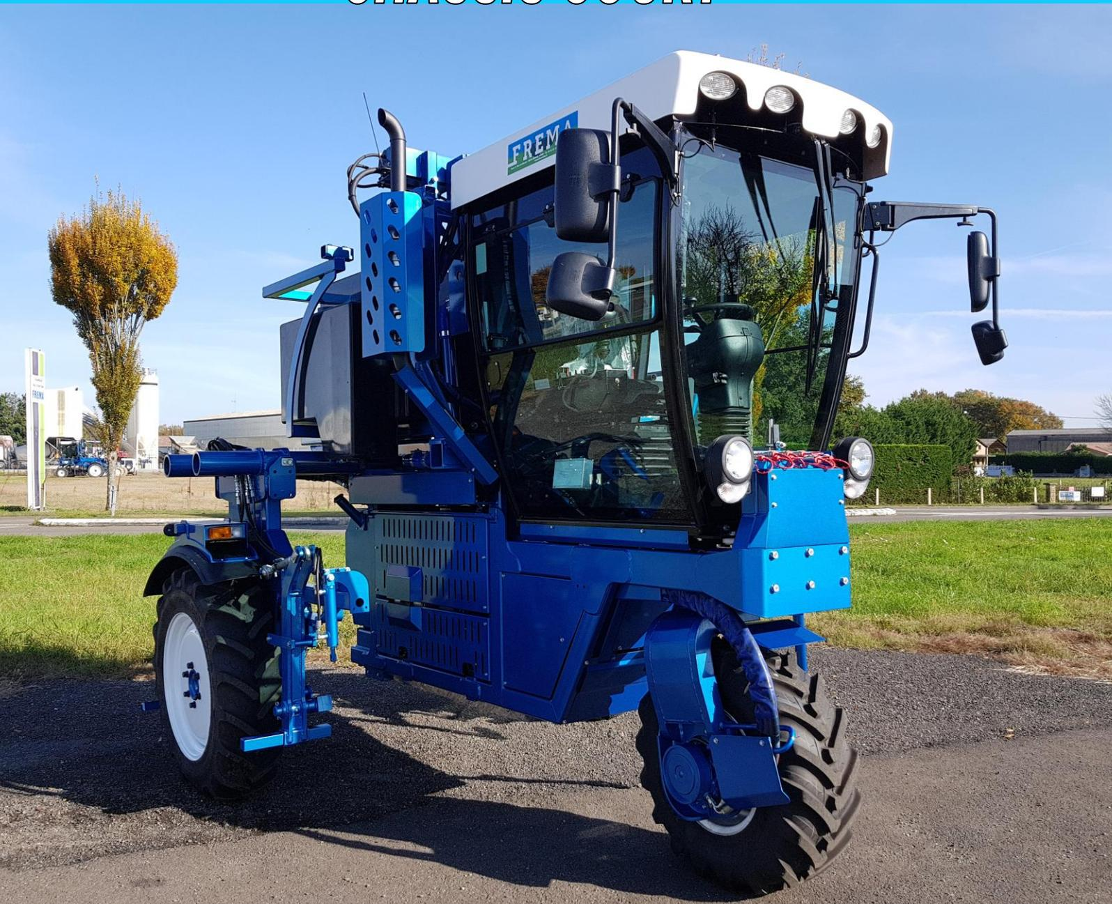
Suspension hydraulique sur roue à l'avant (système breveté)
