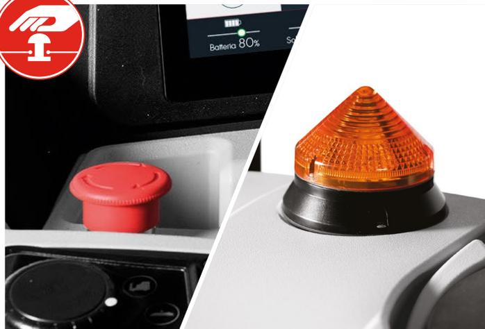
Emergency Stop. En cas d'urgence, il suffit d'appuyer sur un bouton pour que l'avance et toutes les fonctions soient immédiatement bloquées. Le gyrophare permet de rendre la machine visible durant le travail, tandis que l'avertisseur sonore avertit que la machine se déplace en marche arrière.
