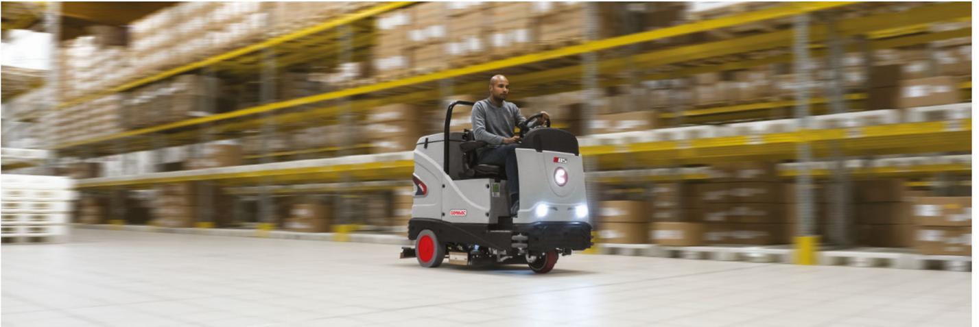
Opérations de nettoyage rapides pour optimiser les temps : jusqu'à 8 km/h durant le travail. Un capteur continu placé sur l'essieu directeur reconnaît la position exacte de la roue motorisée avant et réduit automatiquement la vitesse de la machine selon les besoins. Le capteur permet à la machine d'avancer de manière fluide et sans vides.
