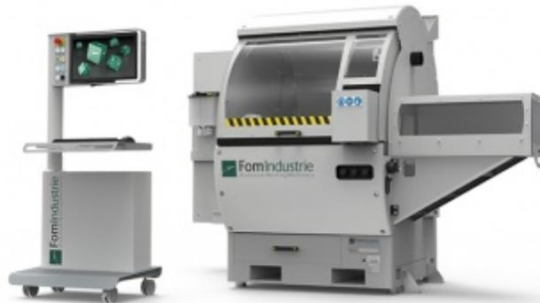
**Tronçonneuse à lame ascendante avec embarreur à axe contrôlé**
