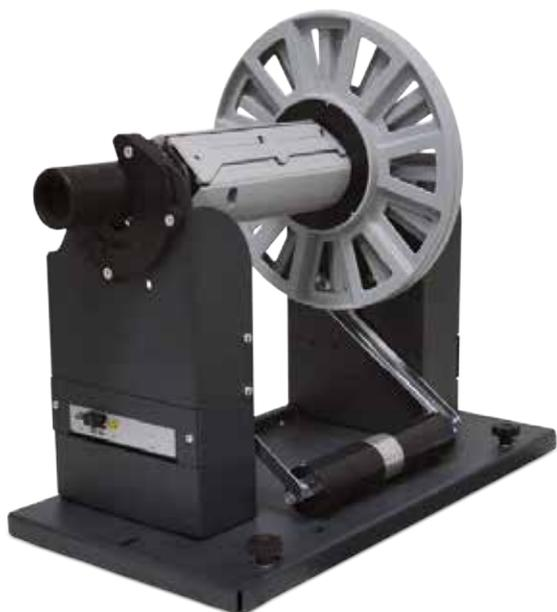
Le porte-mandrin motorisé peut traiter les supports imprimés d'une largeur maximale de 170 mm et des rouleaux de rembobinage d'un diamètre extérieur jusqu'à 250 mm avec un mandrin interne fixe de 3" (76 mm). Les étiquettes seront rembobinées face extérieure.
