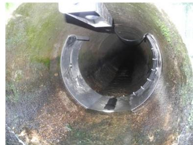
Capteur placé sur un bandeau élastique glissé dans le conduit, ici associé à un capteur ultrasonique à renvoi à 45°.
