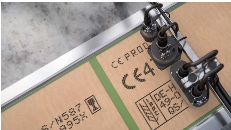
Les têtes d'impression 7, 16 et 32 buses peuvent être combinées librement.
