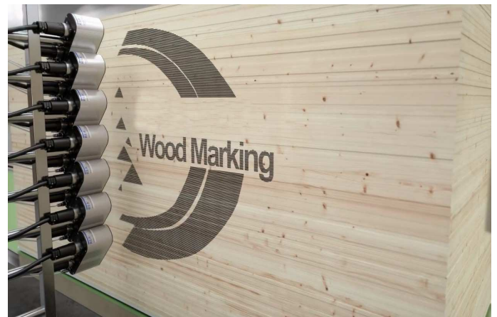
Exemple de marquage de large logo comprenant 7 têtes 32 buses contrôlées individuellement.
