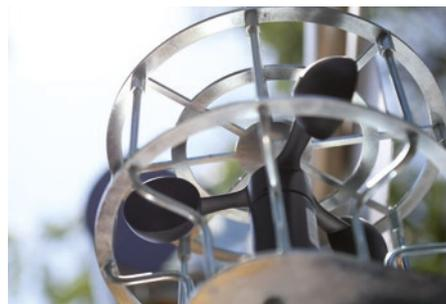
**Anémomètre** de contrôle et avertissement d'atteinte de la vitesse de vent maximale admissible (45 km/h).
