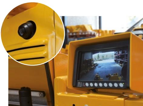
**Caméra de guidage.** Pour améliorer la visibilité du conducteur, il est possible d'installer une caméra et un écran qui permettent de mieux voir le côté opposé de la nacelle élévatrice. Cela facilite également l'alignement par rapport aux rails lorsque la plateforme accède à la voie ferrée.
