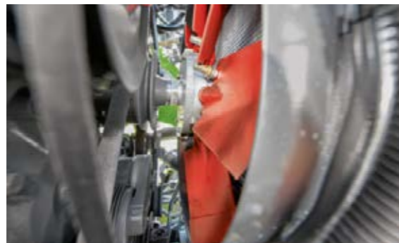
Ventilateur à pales réversibles pour les travaux d'effeuillage. Avantage : possibilité de nettoyer les grilles de refroidissement par soufflage sans sortir de la cabine – pour une performance et une efficacité améliorées.
