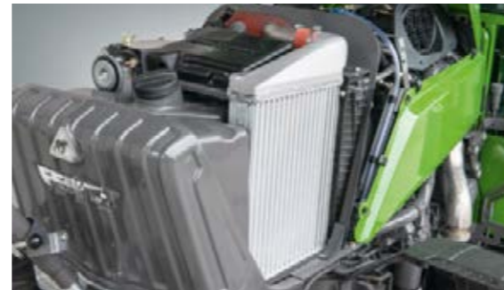
Le système de refroidissement en U possède de larges ouvertures d'admission pour optimiser l'alimentation en air. Avec pour résultat une contamination moindre du refroidisseur, même dans des conditions d'utilisation extrêmes.
