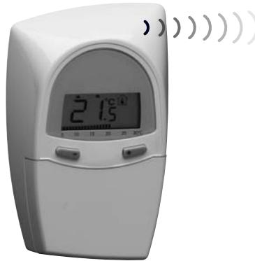
Ce thermostat d'ambiance à transmission radio est conçu pour vous apporter confort et économies d'énergie. Il permet de programmer et de réguler votre chauffage selon 2 niveaux de température (confort et réduit).
