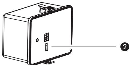
Convient pour les produits d'un courant de charge de max. 1000 mA. Pour charger, raccorder l'appareil à charger au raccordement de chargement USB de l'accumulateur à l'aide d'un câble de chargement USB (voir dessin ②) et mettre le bouton sur la position « II » (USB).
