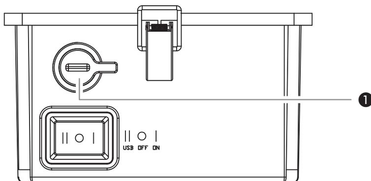
Для включения светильника выключатель нужно перевести в положение «I» (ON/ВКЛ.). Для выключения светильника выключатель нужно перевести в среднее положение «O» (OFF/ВЫКЛ.).
