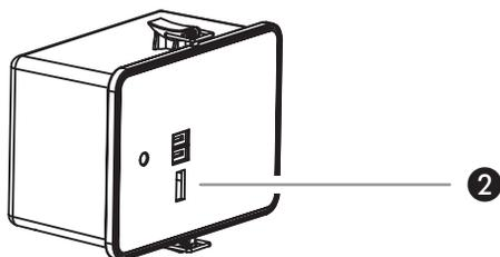
Κατάλληλο για προϊόντα με μέγιστο ρεύμα φόρτισης 1000 mA. Για τη φόρτιση συνδέστε την προς φόρτιση συσκευή μέσω ενός καλωδίου USB φόρτισης στη USB θύρα φόρτισης του συσσωρευτή (βλέπε σχήμα 2) και τοποθετήστε το διακόπτη στη θέση «I» (USB).
