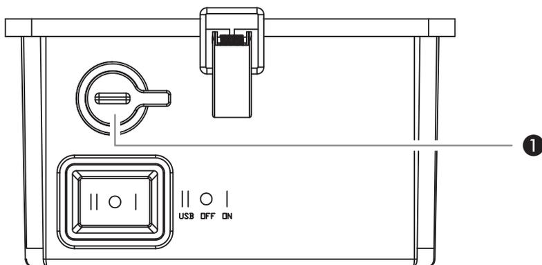
Pour allumer la lampe, mettre le bouton sur la position « I » (ON). Pour éteindre, mettre le bouton sur la position centrale « O » (OFF).
