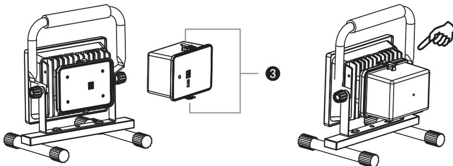
La batteria può essere sostituita in modo semplice e veloce. Per farlo, sbloccare entrambe le chiusure ③ sopra e sotto, vedere illustrazione. In tal modo è possibile, p.es., caricare una batteria e al contempo continuare a lavorare con la batteria di ricambio fornita (a seconda della confezione) o con una batteria di ricambio fornibile separatamente.
