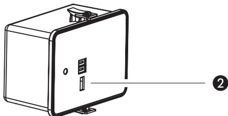
Nadaje się do produktów, których prąd ładowania wynosi maks. 1000 mA. W celu naładowania urządzenie należy podłączyć za pomocą kabla ładującego USB do gniazda ładowania USB akumulatora (patrz rysunek 2) i przełączyć przełącznik w pozycję "II" (USB).
