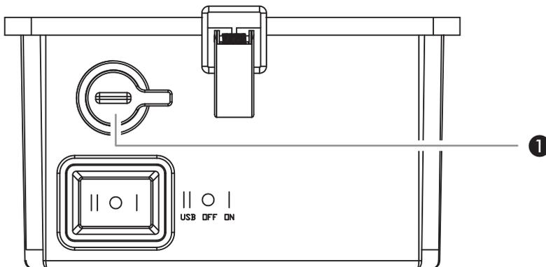
Zum Einschalten der Leuchte den Schalter in Position »K« (ON) bringen. Zum Ausschalten den Schalter in Mittelstellung »O« (OFF) bringen.
