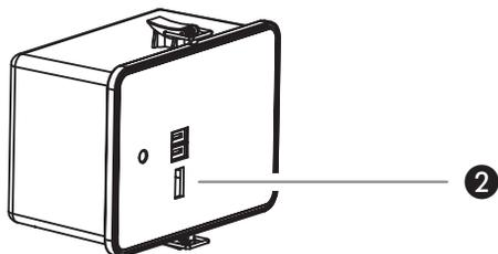
Заряжать можно приборы, рассчитанные на ток зарядки максимум в 1000 мА. Для выполнения зарядки заряжаемый прибор нужно с помощью зарядного кабеля под USB-порт подключить к зарядному USB-гнезду на аккумуляторе (см. чертеж ②) и перевести выключатель в положение «I» (USB).
