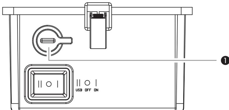
Para ligar o projetor coloque o interruptor na posição "I" (ON). Para desligar coloque o interruptor na posição do meio "O" (OFF).
