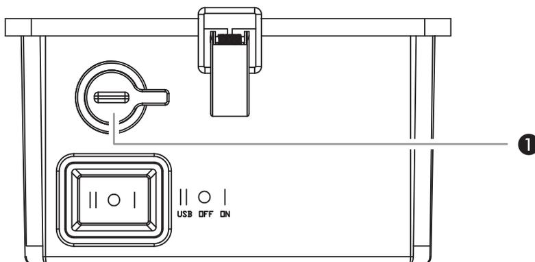
För att sätta på lampan, förs omkopplaren till läge "I" (ON). För att stänga av förs omkopplaren till mittenläget "O" (OFF).
