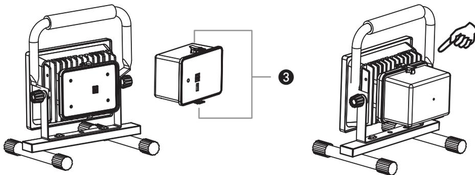
Der Akku kann einfach und schnell ausgetauscht werden. Dazu die beiden Verschlüsse ③ oben und unten entriegeln, siehe Zeichnung. Somit ist es z.B. möglich, einen Akku aufzuladen und gleichzeitig mit dem mitgelieferten Wechselakku (je nach Lieferumfang) bzw. einem separat erhältlichen Ersatzakku weiter zu arbeiten.
