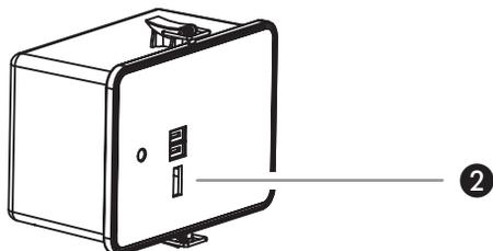
Apropiado para productos con una corriente de carga de máx. 1000 mA. Para cargar el dispositivo conectar el cable USB al puerto USB de carga de la batería (ver dibujo 2) y poner el interruptor en posición "II" (USB).
