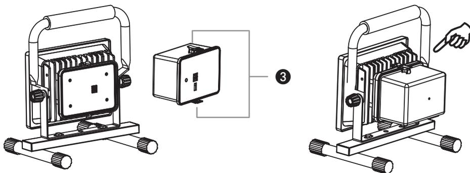
Замена аккумулятора производится быстро и просто. Для этого нужно отпустить оба зажима ③ (верхний и нижний), см. чертеж. В результате можно, например, зарядить аккумулятор и одновременно продолжать работать с использованием входящего в комплект поставки сменного аккумулятора (в зависимости от объема поставки) или отдельно поставленного запасного аккумулятора.
