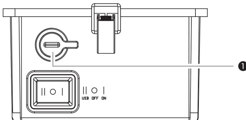
Om de lamp in te schakelen, zet u de schakelaar in de stand "I" (ON). Om de lamp uit te schakelen, zet u de schakelaar in de middelste stand "O" (OFF).
