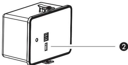
Avsedd för produkter med en laddström på max. 1000 mA. För att ladda upp den urladdade enheten kopplas en USB-laddkabel till USB-anslutningen på batterierna (se ritning 2) och omkopplaren sätts i läge "II" (USB).
