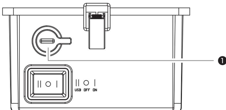
Kytke valaisin päälle asettamalla kytkin asentoon "1" (ON). Sammuta valaisin kääntämällä kytkin keskiasentoon "0" (OFF).
