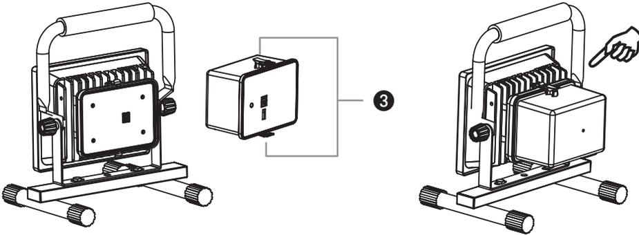
Akü kolay ve hızlı değiştirilebilir. Bunun için üstte ve altta bulunan kilitleri açın 3, bakınız Çizim. Bu sayede örn. bir aküyü şarj etmek ve aynı anda (teslimat kapsamına göre) paket içeriğindeki değiştirme aküsü ya da ayrı satın alınabilir bir yedek akü ile çalışmaya devam etmek mümkündür.
