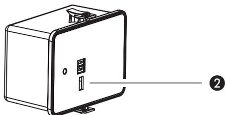
Sobib toodetele, mille laadimisvool on maks. 1000 mA. Laadimiseks ühendage laetav seade USB-laadimiskaabli abil aku USB-laadimispesse (vt joonist 2) ja seadke lüliti asendisse "II" (USB).
