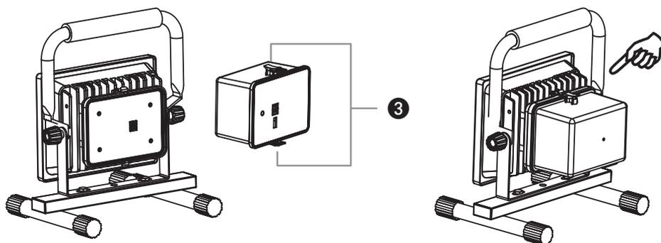
L'accumulateur peut être remplacé facilement et rapidement. Pour cela, déverrouiller les deux fermetures ③ en haut et en bas, voir dessin. Par exemple, il est ainsi possible de charger un accumulateur et, simultanément, de continuer à travailler avec l'accumulateur de remplacement (en fonction de la livraison) ou un accumulateur de recharge disponible séparément.
