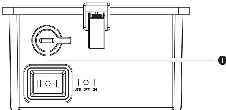
Na zapnutie lampy presuňte vypínač do polohy "I" (ON). Na vypnutie prepnite vypínač do strednej polohy "O" (OFF).
