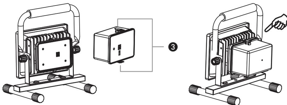
Akumulator je možno zamenjati na preprost in hiter način. V ta namen odklenite oba zapirala 3 zgoraj in spodaj, glej risbo. Tako lahko npr. določen akumulator polnite in hkrati z zraven dobavljenim nadomestnim akumulatorjem (odvisno od obsega dobave) oz. s posebej kupljenim nadomestnim akumulatorjem, nadaljujete delo.
