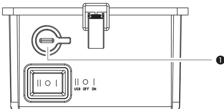
Aby włączyć oprawę oświetleniową, należy przełączyć przełącznik w pozycję "I" (ON). W celu wyłączenia należy przełączyć przełącznik w ustawienie środkowe "O" (OFF).
