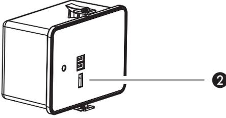
Azami 1000 mA şarj akımına sahip ürünler için uygundur. Şarj etmek için şarj edilecek cihazı USB şarj kablosu ile akünün USB şarj bağlantısına (bakınız Çizim 2) takın ve anahtarı "II" (USB) pozisyonuna getirin.
