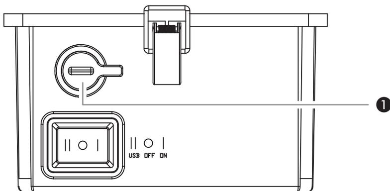
K zapnutí lampy přesuňte vypínač do polohy "I" (ON). K vypnutí přepněte vypínač do střední polohy "O" (OFF).
