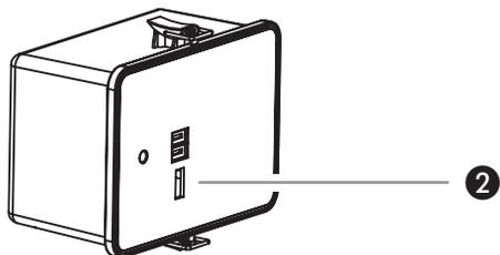
Piemērota produktiem ar maks. 1000 mA uzlādes strāvu. Lai uzlādētu ierīci, pievienojiet to ar USB uzlādes vadu akumulatora USB ligzdai (skat. attēlu 2) un iestatiet slēdzi stāvoklī "II" (USB).
