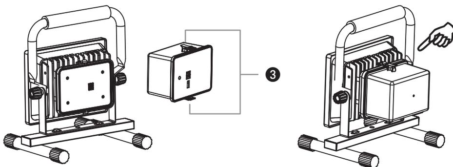
La batería se puede sustituir de manera fácil y rápida. Para ello retire ambos bloqueos 3 arriba y abajo, ver dibujo. De esta manera, se puede cargar la batería de manera separada mientras se trabaja con una batería de repuesto incluida en la entrega (depende del pedido) o con una batería adicional adquirida previamente.
