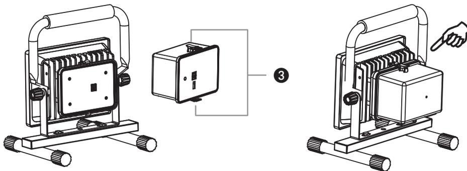
Akumulátor lze snadno a rychle vyměnit. Odblokujte k tomu nahoře a dolů oba uzávěry 3, viz výkres. Tak je např. možné, aby se nabíjel jeden akumulátor a současně se dále pracovalo s dodávaným výměnným akumulátorem (vždy podle obsahu dodávky) nebo separátním náhradním akumulátorem.
