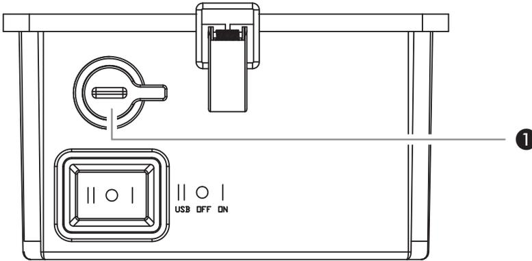
Lambayı açmak için anahtarı "I" (ON) pozisyonuna getirin. Lambayı kapatmak için anahtarı orta "O" (OFF) konumuna getirin.
