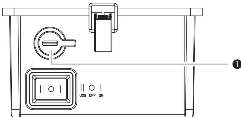
Lai ieslēgtu lampu, iestatiet slēdzi stāvoklī "1" (ON). Lai izslēgtu lampu, iestatiet slēdzi vidus stāvoklī "0" (OFF).
