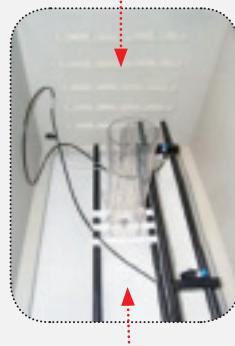
Fond de l'enceinte en inox revêtu de Halar® ECTFE (Polymère fluoré), pour un meilleur échange thermique. Démontable pour un accès facile aux résistances
