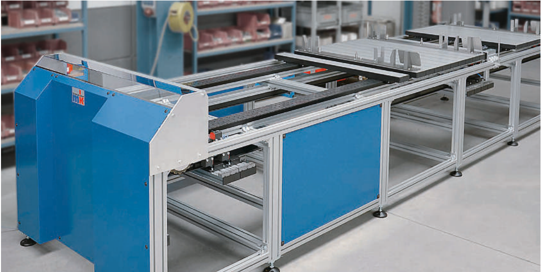
SPU 2040 à double voie avec fonction de séparation pour l'approvisionnement des pièces pour une installation de montage et de soudage
