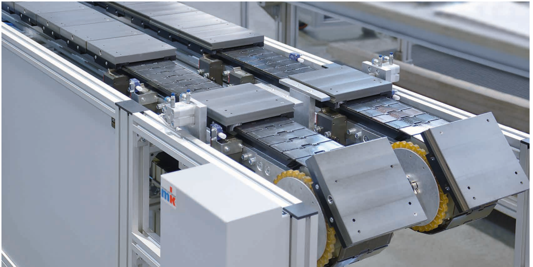
SPU 2040 à deux voies, largeur de chaîne de 114 mm avec positionneur
