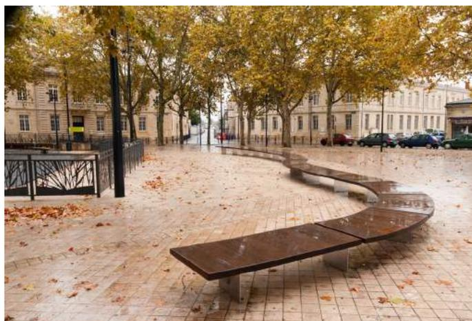
Le motif en arborescence de cette clôture entièrement métallique a été réalisé par le procédé de découpe au laser après numérisation des dessins de conception. Chaque panneau de clôture a dû être fabriqué suivant une hauteur spécifique afin de pouvoir rester horizontal et s'adapter aux pentes du terrain ou du muret sur lesquels ils ont été scellés. La pose réalisée par Mobipose s'est avérée complexe en raison du calepinage très original voulu par les architectes.
