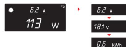
Puissance de production instantanée en Watt, courant de production instantané en A, tension instantanée en V, et historique de production en kWh.
