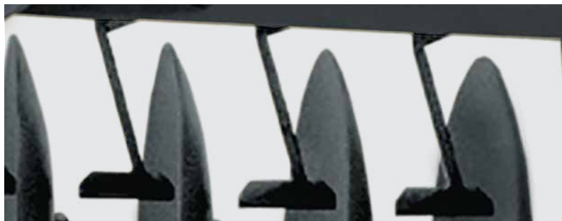
Limpadores de discos com regulagem. Adjustable disc scrapers. Limpiadores de los discos con regulación.
