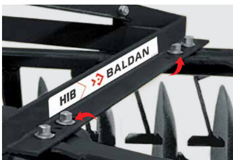
Várias opções de regulagens para maior ou menor ângulo de corte dos discos. Several options for adjustments for a bigger or smaller angle of the discs.
