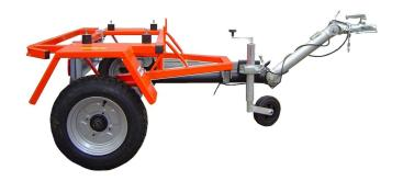
Chariot homologué route Essieu de 400 kg PTAC Attelage articulé à boule ou à anneau (à préciser) Roue de secours (OPTION)
