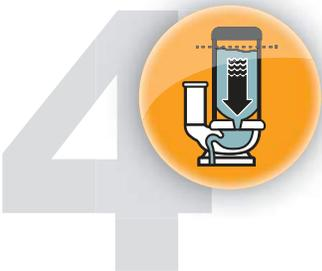
L'appareil emmagasine l'eau souillée jusqu'à ce qu'elle atteigne les électrodes (3 à 5 gal. / 11 à 19L).
