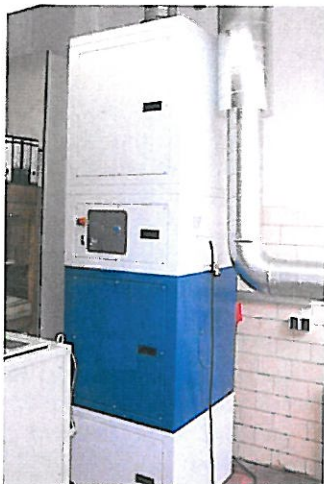
Exemple pour un atelier de soudage – AIRCLEAN CB 2N avec 8 bras d'aspiration
