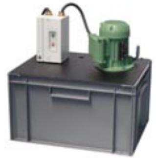
Dispositif de taraudage par télé-inversion du sens de rotation de la broche sur la butée de profondeur
