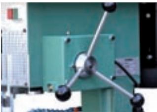
Dispositif de descente lente micrométrique
