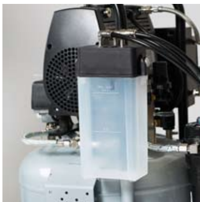
Réservoir de collecte des condensats
