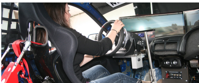
Ressentez la piste, via le siège monté sur vérins électriques
