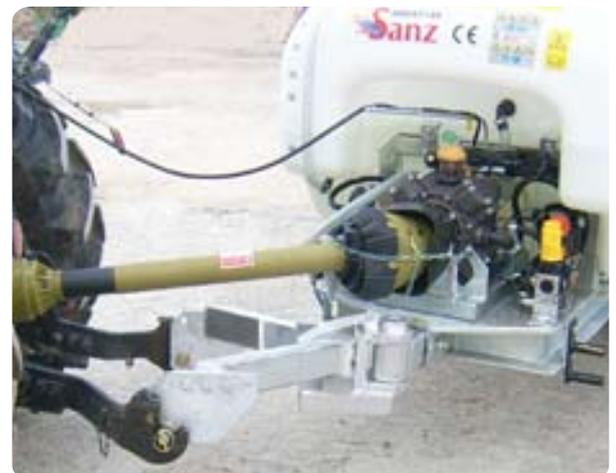
Monté sur roulement avec cardan homocinétique
