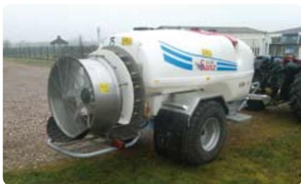
Redresseur d'air en soufflerie avec accélérateur de sortie
