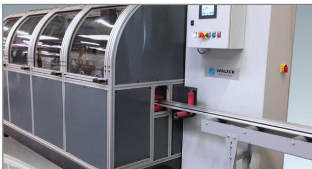
Cette machine permet l'ébavurage des profilés de façon simple et rapide, en effet, les quatre faces sont réalisées en un seul passage.
