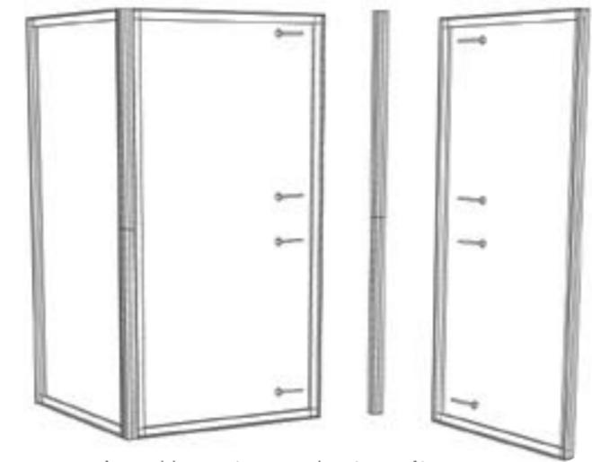
Assemblage entre un cadre et un mât
