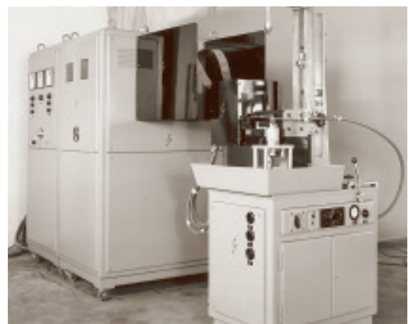
Fin 1950, la pionnière (première machine de trempe universelle de FDF) est prête pour l'embarquement.
