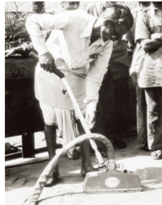
Les équipements d'EFD Induction sont utilisés et appréciés dans le monde entier depuis des décennies. Cet instantané de 1986 montre des employés de Garden Reach Shipbuilders and Engineers Ltd., à Calcutta, en Inde, en train de tester leur nouvelle machine de chauffage par induction ELVA TERAC 16. Ce système était utilisé pour redresser la coque des bateaux.
