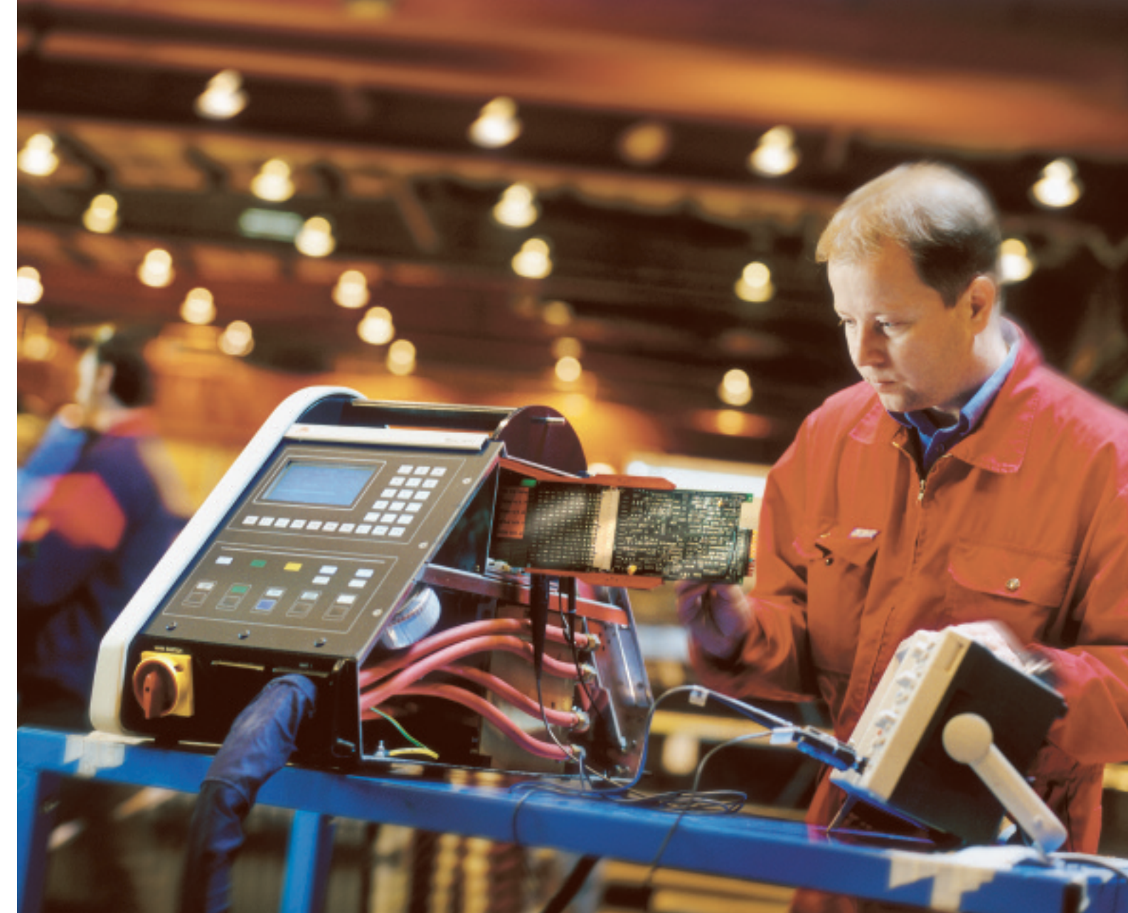
La gamme de services d'EFD Induction couvre toutes les étapes, de la planification de la pré-production et de l'analyse des matériaux jusqu'aux contrats d'entretien préventif et correctif. Ici, l'un de nos ingénieurs effectue la mise à niveau d'un système de chauffage par induction mobile Minac.
