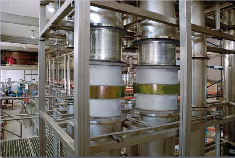
Banc d'étalonnage pour DN150 à DN1000
