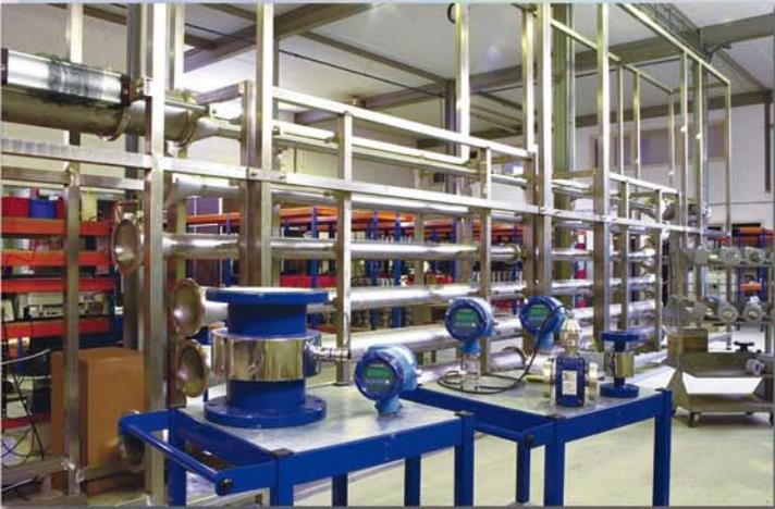
Banc d'étalonnage pour DN3 à DN150
