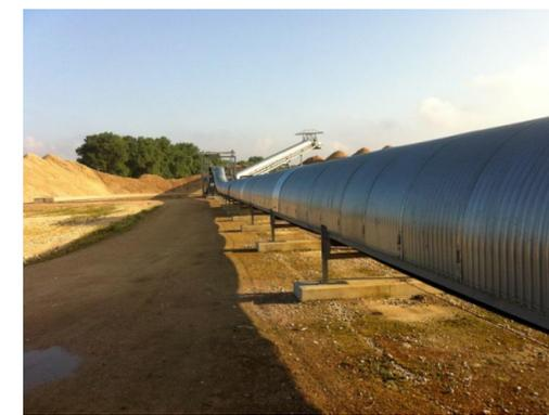
Convoyeur à bande équipé de capots galvanisés
