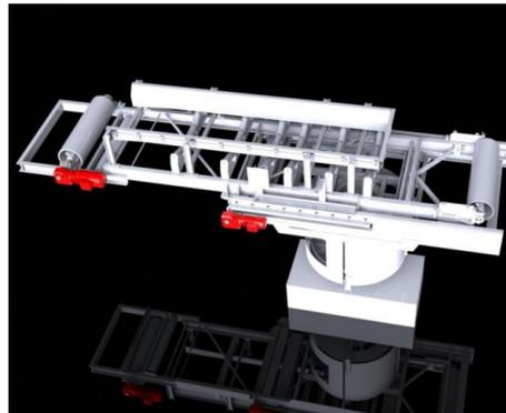
Convoyeur rotatif muni d'une tête mobile
