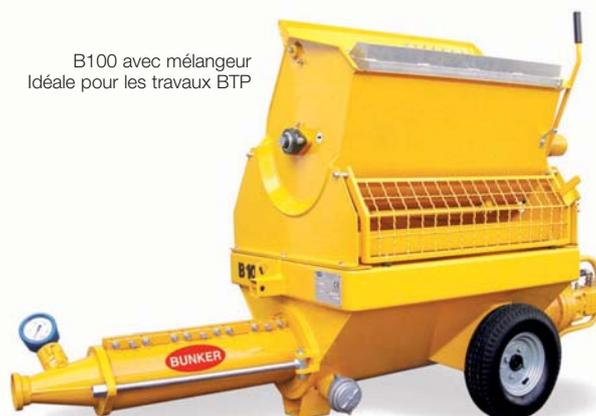
\*Avec stator et rotor 2R8: pression 25 bars, distance Horizontale 60 m, verticale 30 m, granulométrie max. 16 mm, débit théorique 170 l/min
