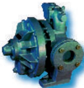
Les pompes séries "TM" sont à piston excentré. La faible rotation de la pompe et le rattrapage automatique assurent longévité et préservation des caractéristiques originelles. L'amorçage est automatique. Des groupes adaptés au transfert de F.O.D ou fuels lourds assurent un service permanent.
