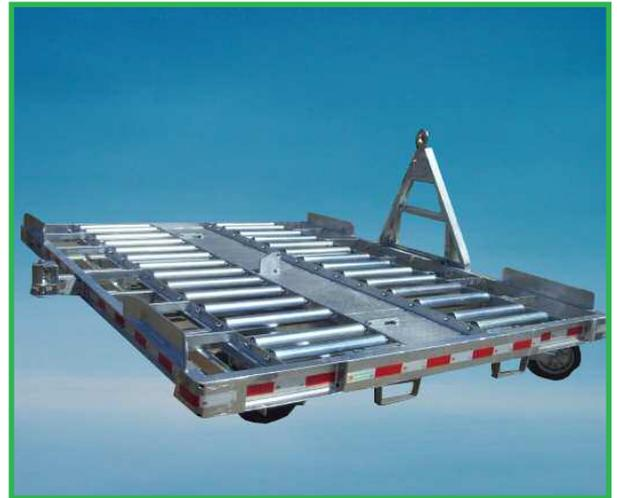
Remorque aéroportuaire 10 pieds à chargement transversal par le petit côté permettant d'assurer le transport et la manutention de fret conditionné sur palettes ou conteneurs aéronautiques. Capacité 7 tonnes.
