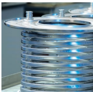
Echangeurs de chaleur Inox-Radial en cours de production
