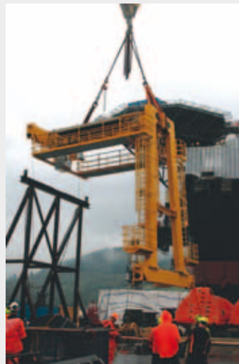
Pont roulant hydraulique sur mesure, de capacité 80 tonnes, utilisé sur un puits de forage
