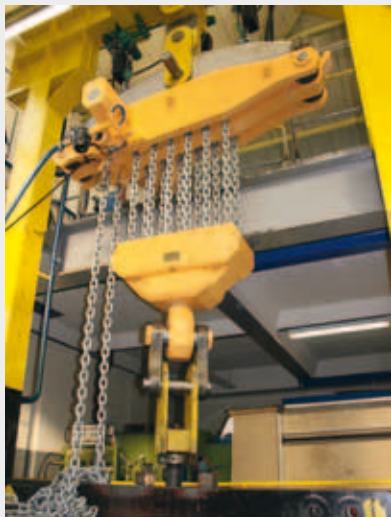
Le premier palan pneumatique au monde, de capacité 125 tonnes : EH 125
