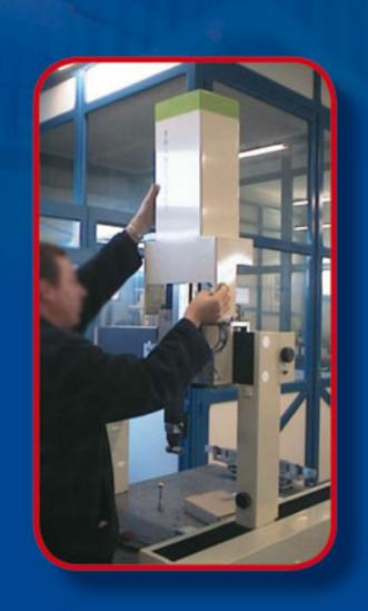
Les instruments non conformes aux exigences normatives ou hors d'état de marche peuvent être réparés avec l'accord du client. Après réparation, un étalonnage avec fourniture d'un certificat ou une simple validation de l'intervention est possible.
