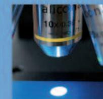
L'échantillon est placé sur la platine et éclairé par un éclairage coaxial ou par un éclairage annulaire qui sont tous deux optimisés pour apporter le maximum de lumière.
