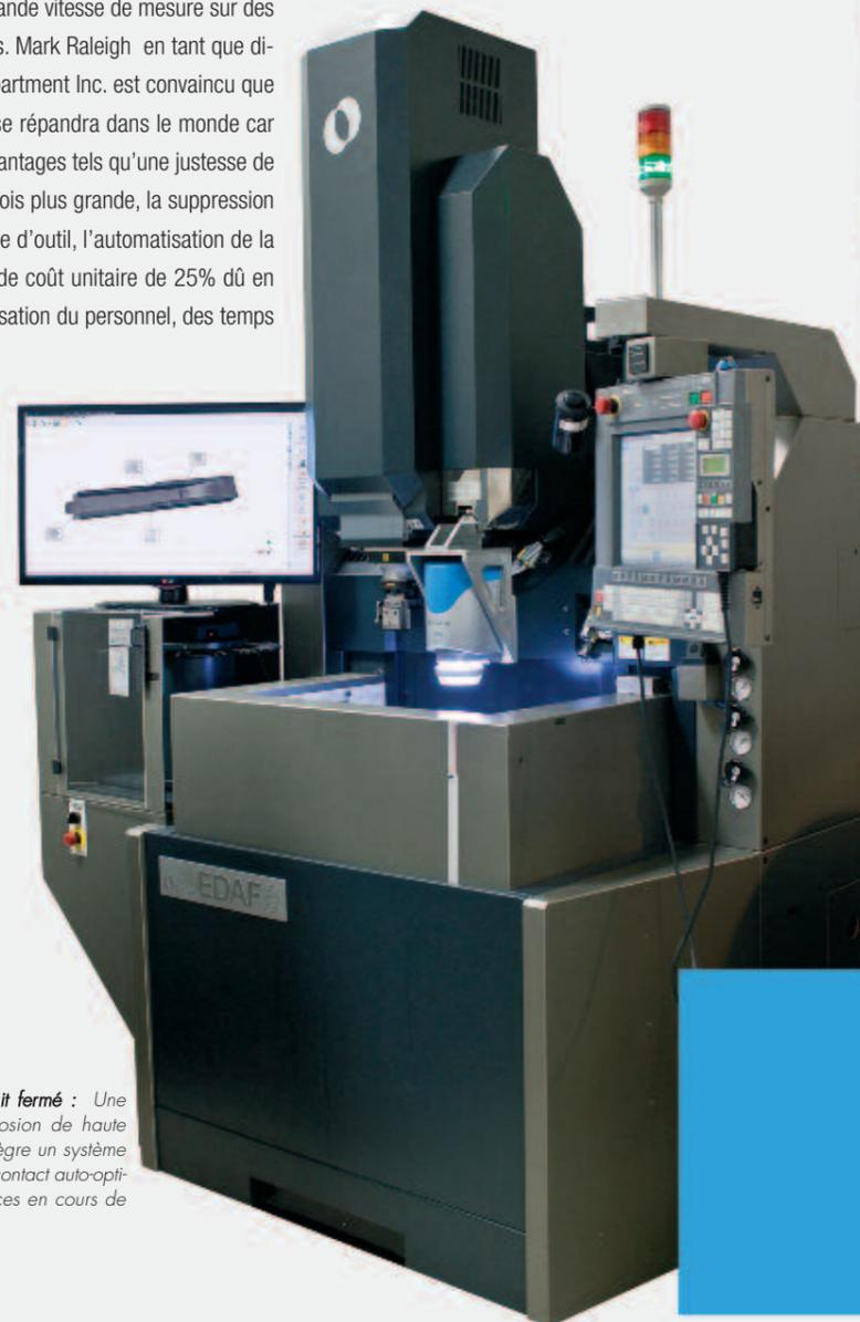
**Fabrication en circuit fermé :** Une machine d'électroérosion de haute performance qui intègre un système de mesure 3D sans contact auto-optimise ses performances en cours de production.
