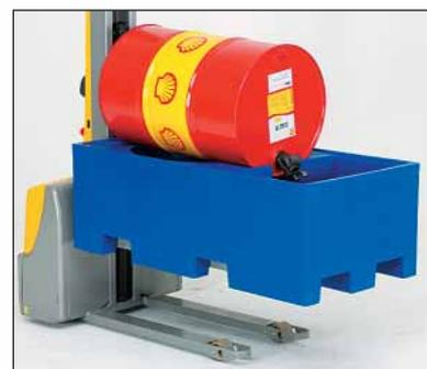
support pour fûts, convient aussi au transport intérieur; grilles galvanisées en option; dans le fond pour fût couché, au-dessus pour fût debout
