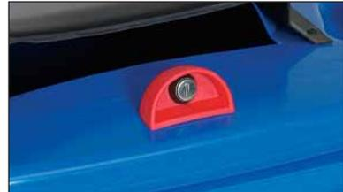
**serrure à gravité, s'ouvre (uniquement) en basculant le conteneur, modèles à clé triangulaire ou ordinaire**
