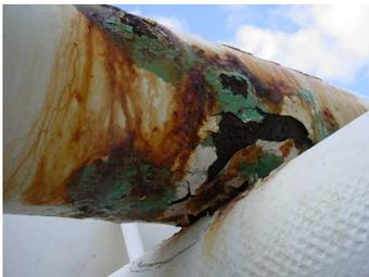
TOTAL finance le projet SYSTRA (*Nouveau système de détection rapide d'intégrité de structures gazières et pétrolières on et offshore en milieu hostile*). L'objectif de ce projet est de développer des technologies par ondes guidées moyenne et haute fréquence pour la caractérisation de l'état de corrosion dans les zones difficiles d'accès : corrosion sous support, bacs de stockage (*contrôle par l'extérieur sans vidange du bac*).
