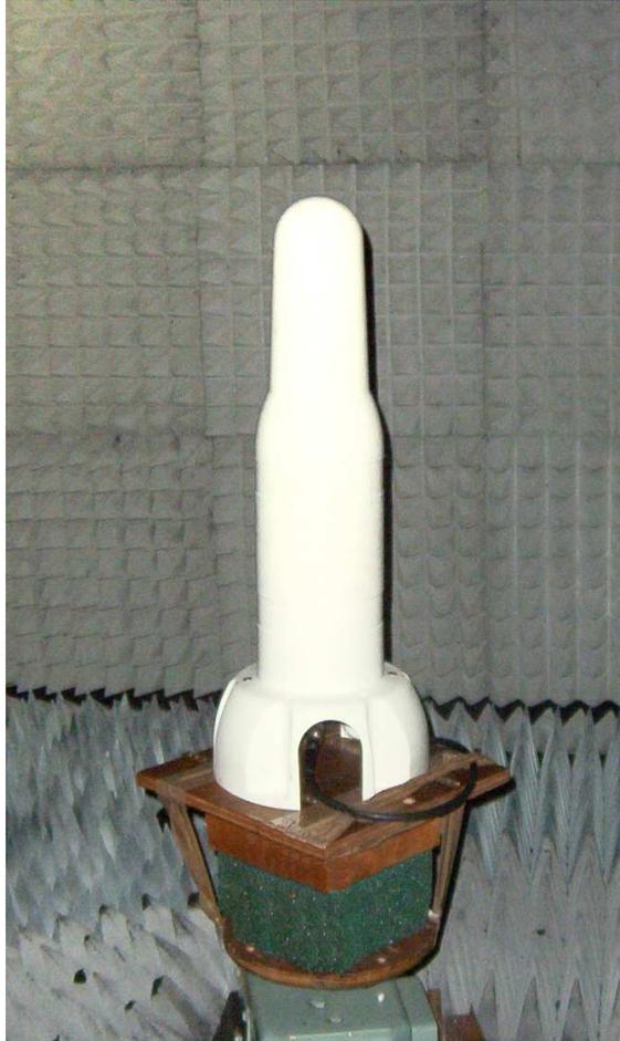
Figure 6. Test d'émetteur/récepteur en chambre sourde
