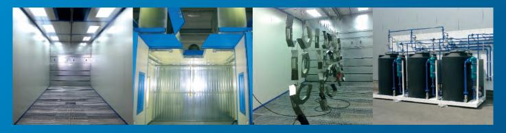
► Cabines de grenaillage - Corindon - Métallisation - Ponçage
