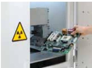
Grande porte avec fonction coupure automatisée des rayons X
