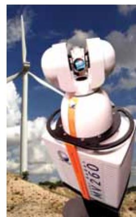
Le Radar Laser est de plus en plus utilisé sur le marché des énergies vertes car il est capable de mesurer des structures fragiles de grande dimension comme les panneaux solaires et les pales de turbine
