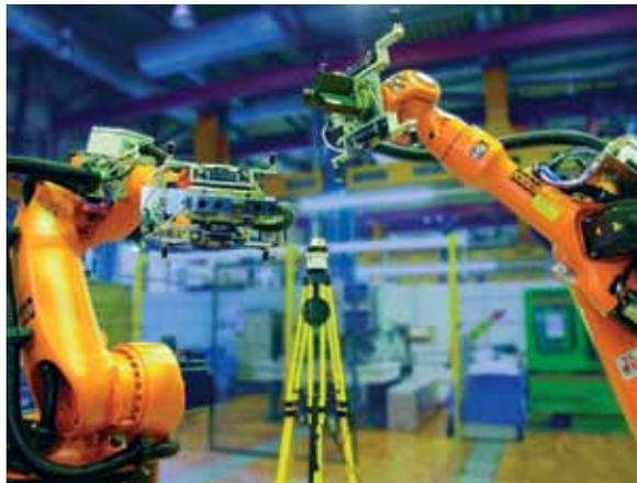
Le Contrôle Adaptatif Robot – piloté par MMT optique ou iGPS – met en place une boucle de rétro-action fermée qui élimine les conséquences du pré-chauffage, de la dérive et des jeux.
