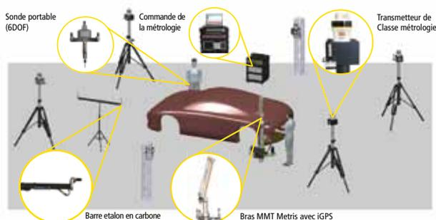
iSpace permet l'utilisation simultanée d'un nombre illimité de sondes portables et de capteurs de repérage
