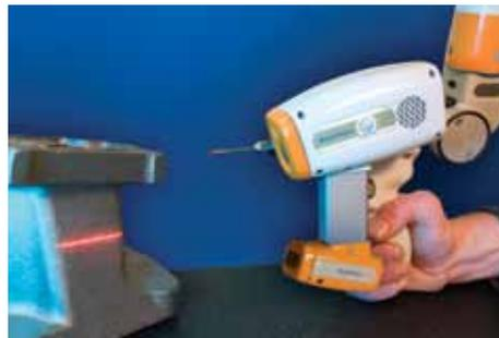
Le scanner MMC est disponible avec des largeurs de faisceau de 40/80/160mm et une vitesse d'acquisition de 24.000 points/seconde.
