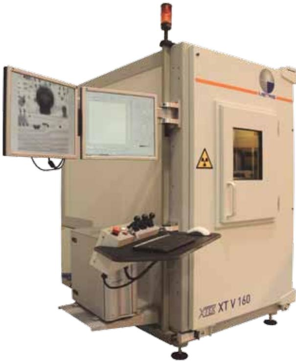
De nos jours, les cartes de circuits imprimés sont si densément garnies que les connexions de composants sont cachées par d'autres composants, faisant ainsi des rayons X la seule solution d'inspection réellement applicable. Le XT V 160 est un système d'inspection des circuits imprimés facile à utiliser, rentable et de grande qualité, destiné aux lignes de production et aux laboratoires d'analyse de rupture de pièce.
