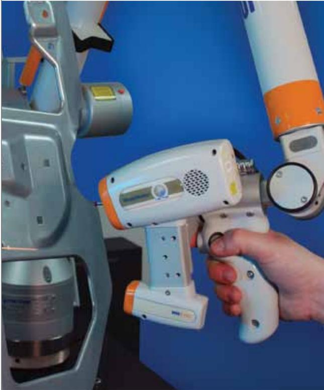
Les scanners portables de la gamme ModelMaker sont les outils de numérisation parfaits pour toutes les applications d'inspection 3D et la rétro-conception. ModelMaker utilise une vraie caméra numérique, et c'est un vrai bond en avant dans le scanning laser 3D, car il apporte de meilleures performances des palpeurs, des vitesses d'acquisition élevées et un faisceau plus large (jusqu'à 200 mm) pour un scanning ultra productif.
