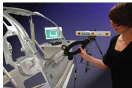
MMT optique K-Series avec SpaceProbe pour le mesurage de grands volumes
