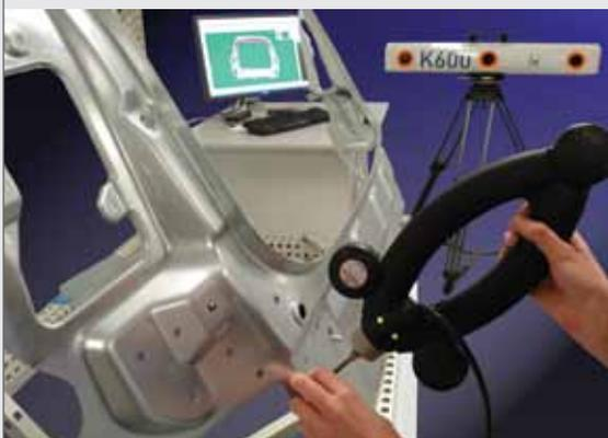
Le scanner K-Scan MMD est un scanner portable pour la métrologie des grands volumes. Suivi précis et en continu des sondes grâce au système MMT optique et aux 20 marqueurs infrarouges intégrés dans le scanner laser. Cela permet d'éliminer toutes les contraintes mécaniques afin de réaliser un scanning sans effort.
