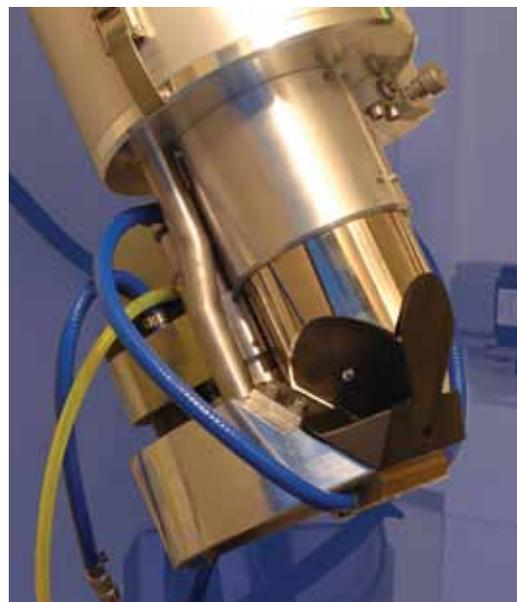
Une source de rayons X avec cible tournante multiplie par 5 la vitesse du flux de rayons X. Le client peut alors acquérir plus rapidement des données ou obtenir des données encore plus précises pour la Tomographie Numérique, dans le même laps de temps.
