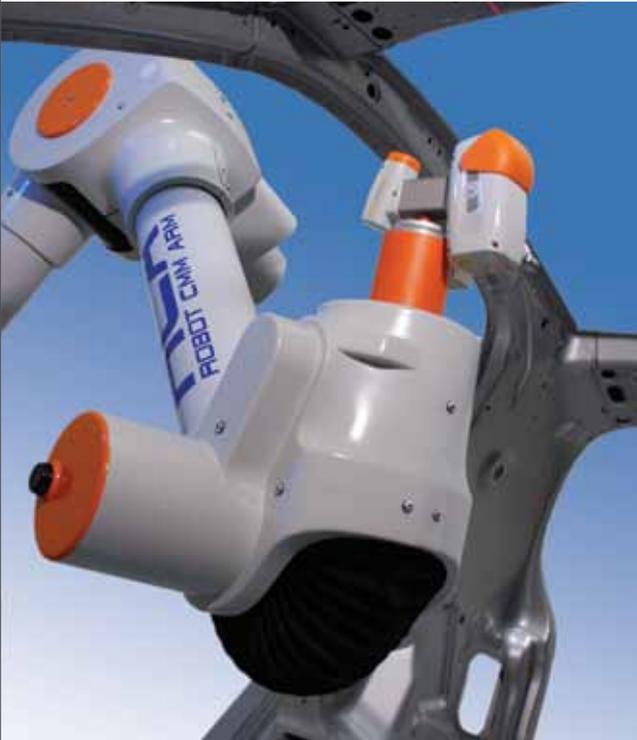
Le bras RCA est la combinaison de deux mondes. Il additionne les capacités d'automatisation d'une MMT traditionnelle et la mobilité et l'accessibilité à la pièce que permet un bras articulé. Afin d'accélérer l'inspection 3D répétitive, le bras RCA combine un bras articulé à 7 axes internes et un squelette externe, entraînés par des moto-réducteurs.
