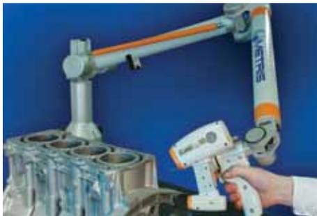
Le scanner MMD est disponible avec des largeurs de faisceau de 50/100/200 mm et une vitesse d'acquisition maximale de 80.000 point/seconde.
