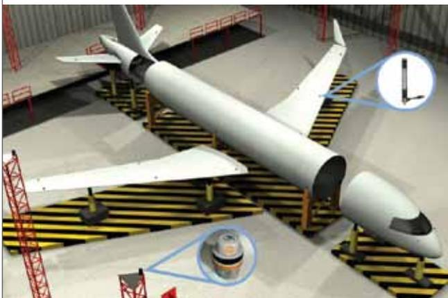
iGPS est une solution à grande échelle grâce à laquelle de grandes installations deviennent accessibles à la métrologie de précision. A l'intérieur des locaux, un nombre illimité de sondes de mesure portables ou de capteurs de positionnement (fixés sur les outils et les pièces) fonctionnent simultanément.
