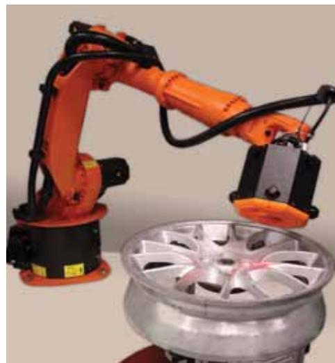
Scanning laser rapide et répétitif pour une inspection sur la ligne de production
