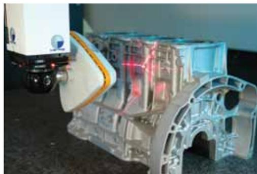
La grande profondeur de champ du scanner permet de gagner du temps pendant l'inspection de pièces moulées pour l'automobile.
