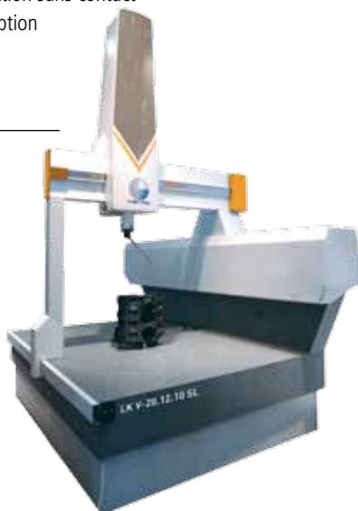
LK V-SL apporte une précision inférieure au micron : ses performances de scanning et d'inspection sont remarquables.
