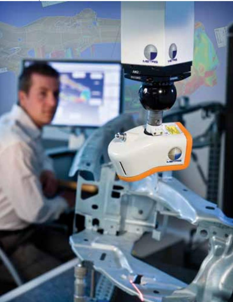
Equipé de la technologie ultra-moderne CMOS et d'un système de traitement de données puissant et intégré, le scanner LC60D pour MMT fait plus que tripler les vitesses de scan qu'on rencontre habituellement aujourd'hui. Cela permet aux fabricants de diminuer considérablement les temps d'inspection des pièces de forme libre, ou d'augmenter nettement le nombre d'entités géométriques qui peuvent être scannées en même temps.
