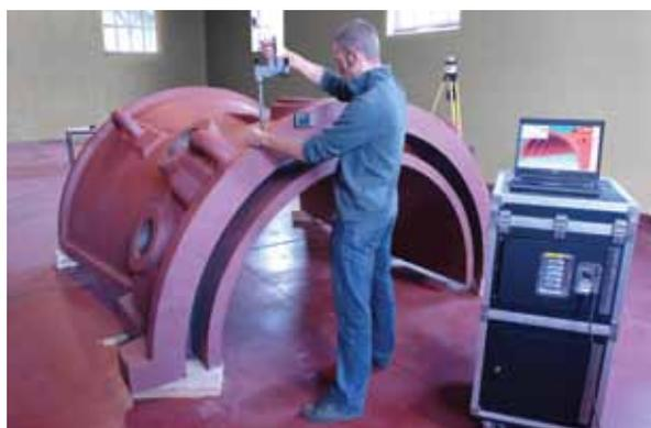
Avec iProbe, l'opérateur peut se déplacer librement dans un grand espace pour réaliser des mesures.
