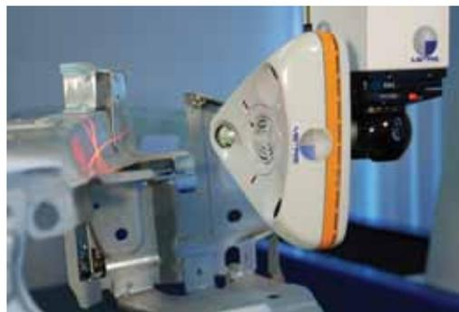
Le XC65D est le bon choix de scanner pour l'inspection des tôles et des formes complexes.
