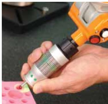
MCA se décline en versions 6 ou 7 axes pour faire des mesures à déclenchement par contact ou au scanner laser.
