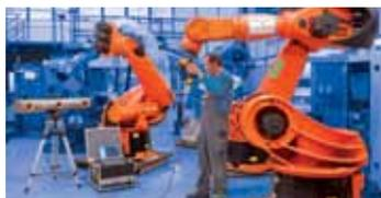
En plus des scanners de repérage (K-Scan-MMD et K-Robot), les MMT optiques K-Series peuvent être utilisées pour la calibration des robots industriels. En association avec le logiciel ROCAL de calibration des robots, on génère une signature du robot qui prend en compte tous les paramètres cinématiques et de déformation identifiés, ce qui permet d'obtenir des précisions absolues inégalées dans tout le volume de travail du robot.
