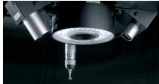
Les capacités du système multi-capteurs rendent possible la mesure des coordonnées des surfaces et des contours, même sur des pièces complexes en 3D.
