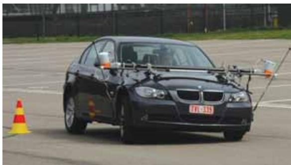
Test de slalom pour analyser le comportement des roues
