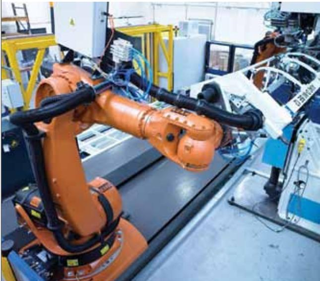
Le contrôle adaptatif robot met en jeu une boucle de rétro-action fermée contrôlée par la métrologie qui permet d'améliorer la précision des robots industriels. Que les robots soient utilisés pour l'usinage, l'inspection, pour appliquer un cordon de soudure ou manipuler des objets, les tâches du robot sont exécutées avec une précision absolue de 0,1 mm, indépendamment des inconvénients comme les jeux, la déformation mécanique ou les effets thermiques.
