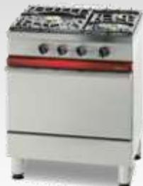
Dimensions: L700 x P650 x H900 mm habillage et façade inox Sécurité par thermocouple Grilles fonte 2 brûleurs de 3kW et 1 de 5kW
