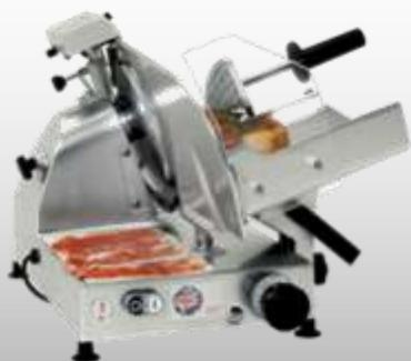
Lame : Ø300 mm, Entraînement par courroie
