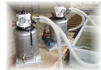
Station de production d'eau potable 2m 3 /h spécialement étudiée pour la Sécurité Civile avec un conditionnement adapté pour une ½ palette de DASH 8
