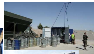
Station de production d'eau potable 2m 3 /h spécialement étudiée pour la Sécurité Civile avec un conditionnement adapté pour une ½ palette de DASH 8
